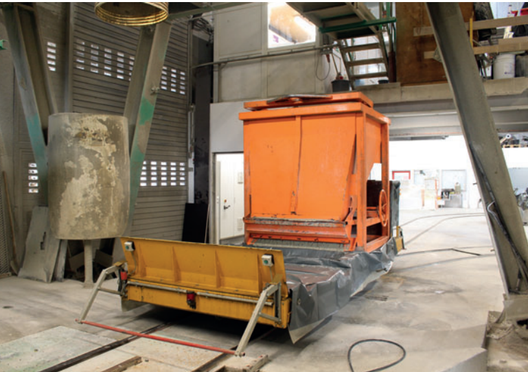
Über den Flurtransportwagen erfolgt der Transport des Betons in die beiden Produktionshallen.
